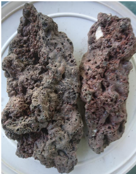
Figur 19. Slagging av bottenaska. Samförbränning av 30 vikts-% torkat avloppsslam med 70 vikts-% träflis (TF)
